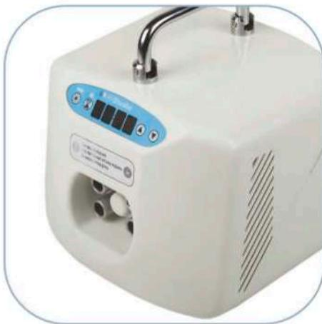
Biliflex está diseñado para la reducción efectiva y rápida de los niveles de bilirrubina en los recién nacidos con ictericia mediante la aplicación de luz terapéutica intensa, continua y uniforme de un estrecho espectro médico de 450-480 nm directamente en la piel de un recién nacido.
